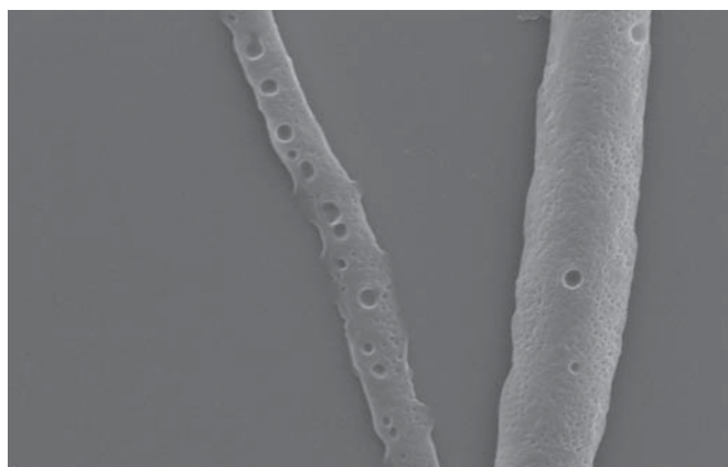
5 Микрофотография пористых полимерных волокон, предназначенных для постепенного выделения АМП
