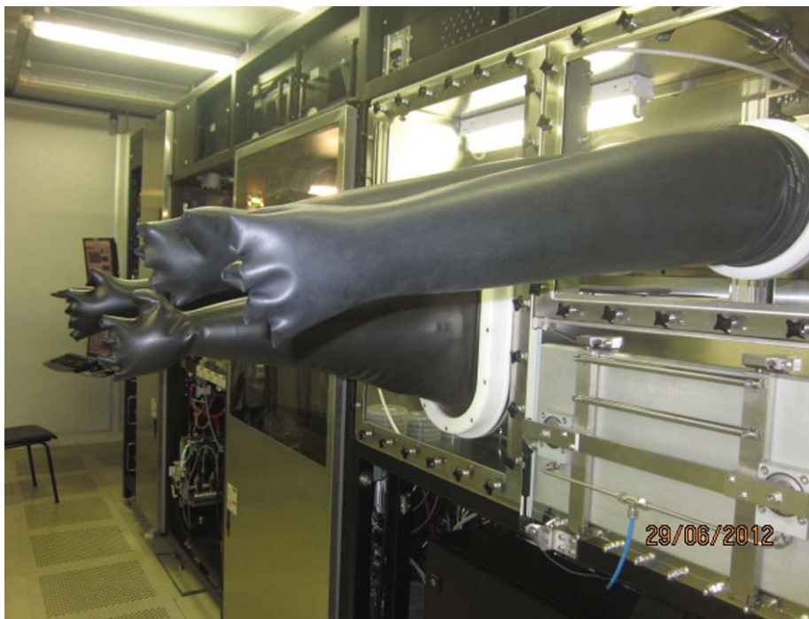
Реактор полностью отделен от окружающей среды. Поэтому пластинки монокристалла германия в установку загружают через шлюз, затем с помощью перчаток устанавливают в приемное устройство, и далее они попадают в реакционную камеру, где на них наносят слои будущего фотоэлемента
