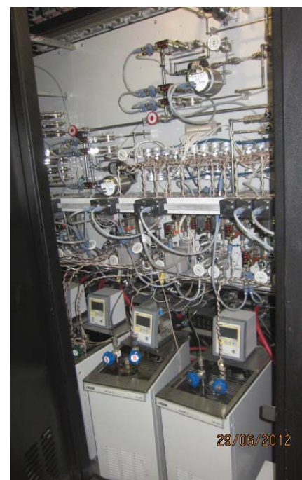
На фото внизу — готовые солнечные элементы. На фото справа — обратная сторона реактора, где находятся датчики и насосы, регулирующие перемещение реагентов по трубопроводам
